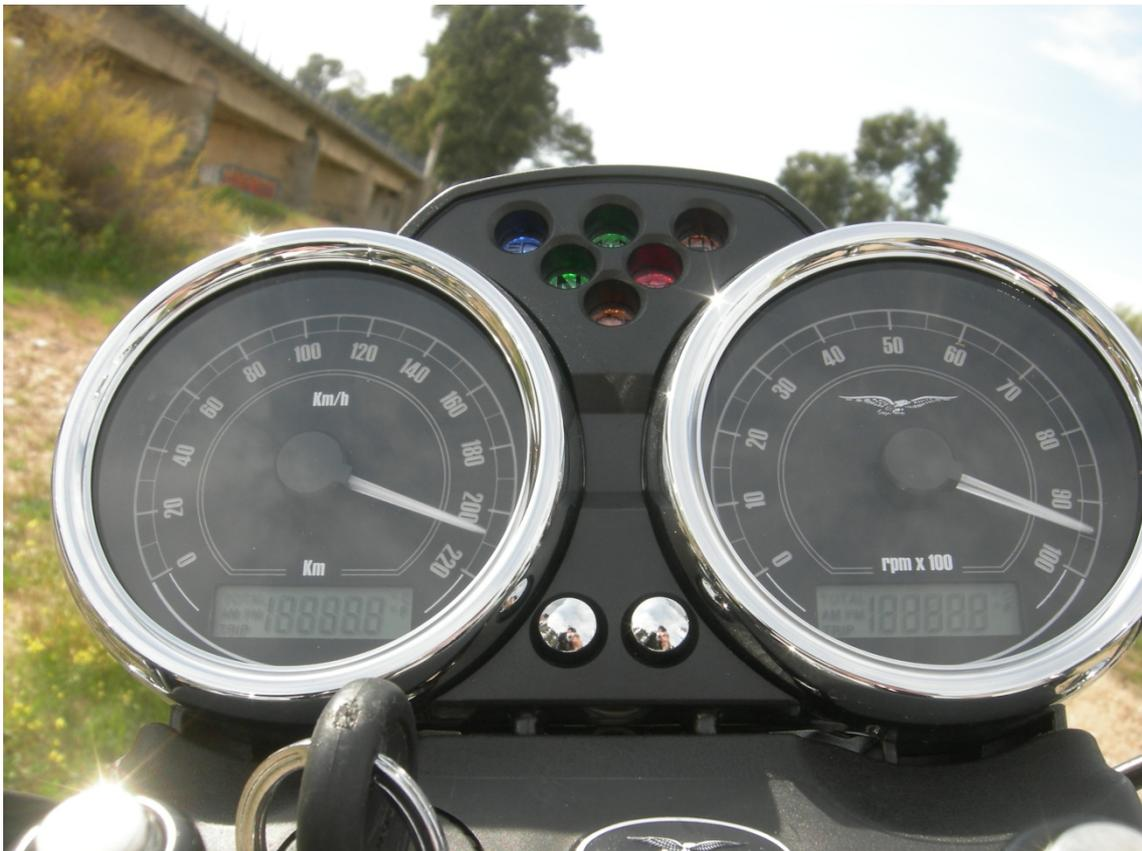
El cuadro, dos esferas de exterior cromado, serias, de buena visión y con una pantalla digital (LCD) incorporada a cada una de ellas, nos ofrece la información suficiente. La pantalla del lado derecho nos indica la hora y temperatura del aire en grados C o F según prefieras (extremos de visualización -10 y +60° C), mientras que la pantalla de la izquierda indica el odómetro total y el parcial.
