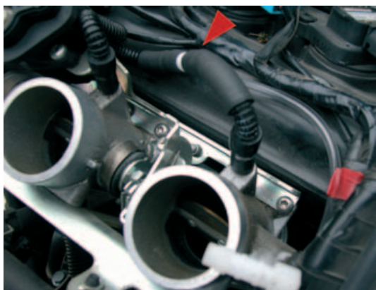
"T" ya instalada en el tubo de vacío y salida hacia el RMV
