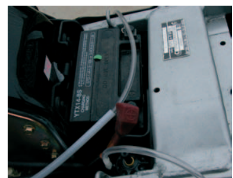
Manguito de entrada de aire al RMV y manguito de salida con el aceite
