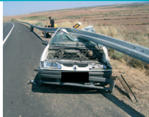
Barrera de seguridad metálica. Resultados en un coche
