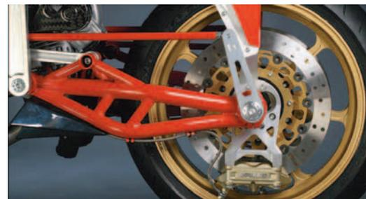
Fig.7 Basculante delantero. Bimota Tesi 3D
