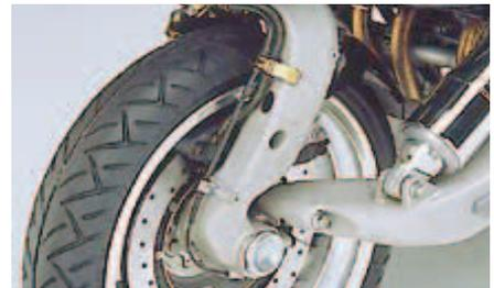
Fig.8 Sistema de suspensión delantero de la Yamaha GTS1000
